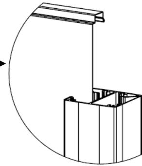
Sens de pose: Face plane de la lame côté extérieur propriété
