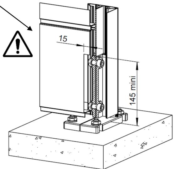
Si platine PL18: Recouper la 1<sup>ère</sup> lame de 15mm sur 145mm de haut minimum (à chaque poteau).
