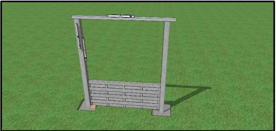
**Étape n°7 :** Procéder de la même façon pour les autres poteaux. Si vous terminez par une travée plus courte, utiliser un disque à matériaux pour couper les plaques.
